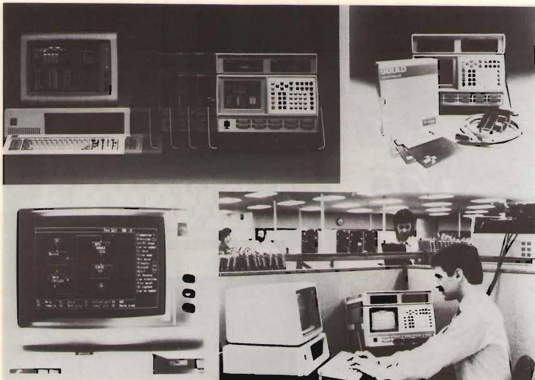
*Il nuovo pacchetto integrato hardware-software Gould, composto da cavo scheda GPIB/manuali/tre floppies, per semplificare impiego logic analyzer K105-D in Stabilimento (Ricerca, Produzione).*
